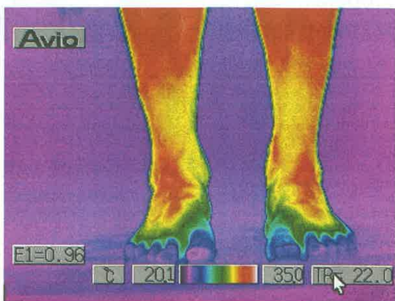
Mit einer Wärmebildkamera konnten die unterschiedlichen Temperaturzonen an den Füßen der Testpersonen sichtbar gemacht werden. Blaue und pinke Zonen sind besonders kalt, rote sehr warm.
