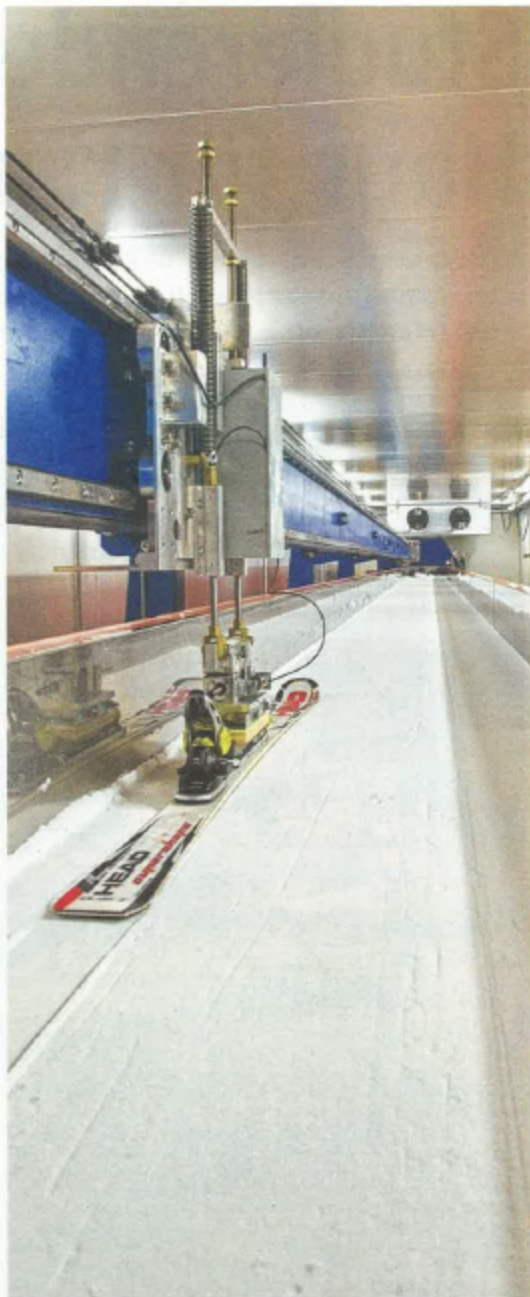
Mit bis zum 100 km/h rast der Ski auf einem Messschlitten über die speziell präparierte Schneeaufflage.
