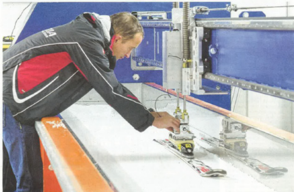
Michael Hasler justiert den Ski am Aluschlitten des Tribometers für die Messung.
