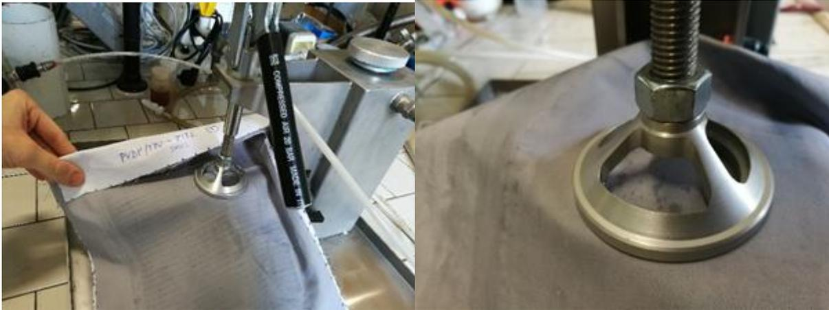
Abbildung 136. Wassersäulentest an laminierten Proben
