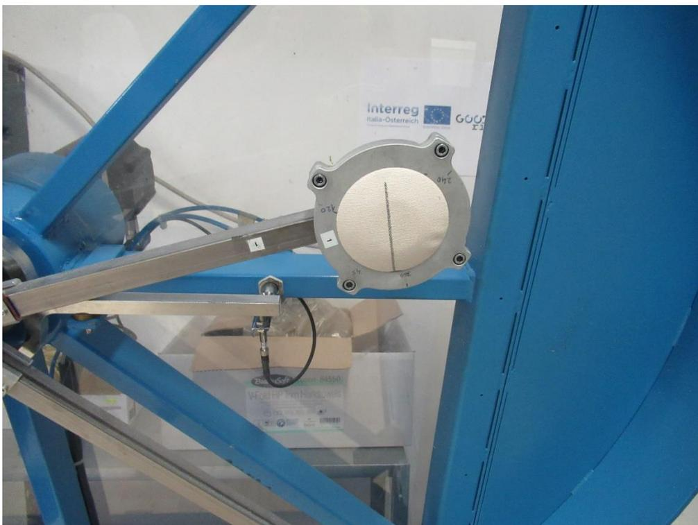
Abbildung 104 Attrezzatura per la determinazione coefficient d'attrito in laboratorio – Particolare portacampione
